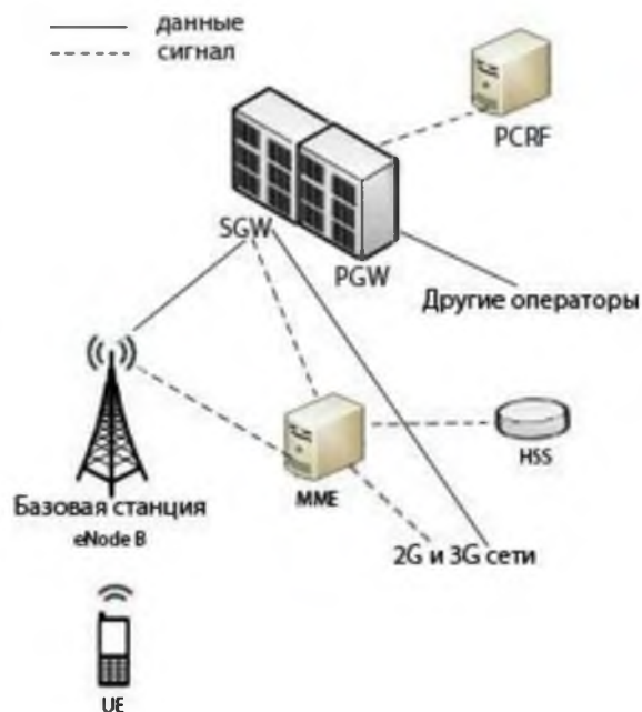
Рис.1. Структура сотовой сети стандарта 4G (LTE)
